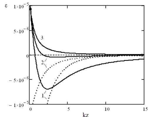
Рис. 3. Поведение функции  $\varepsilon(kz)$  при различных значениях  $\text{Im}(\varepsilon_1)$ , кривые: 1 -  $\text{Im}(\varepsilon_1) = 2.4 \cdot 10^{-5}$ , 2 -  $\text{Im}(\varepsilon_1) = 1.14 \cdot 10^{-5}$ , 3 -  $\text{Im}(\varepsilon_1) = 0$ .
