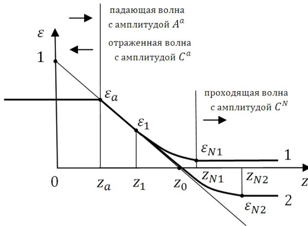
Рис. 1. Линейный слой сопряженный в окрестности нуля  $\varepsilon$  с нелинейным. Кривые 1-2 соответствуют различным аппроксимациям линейного слоя.
