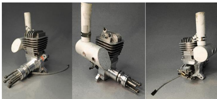
Рисунок 1 – Внешний вид авиационного поршневого двигателя мощностью 5 л.с. разработки Самарского университета
