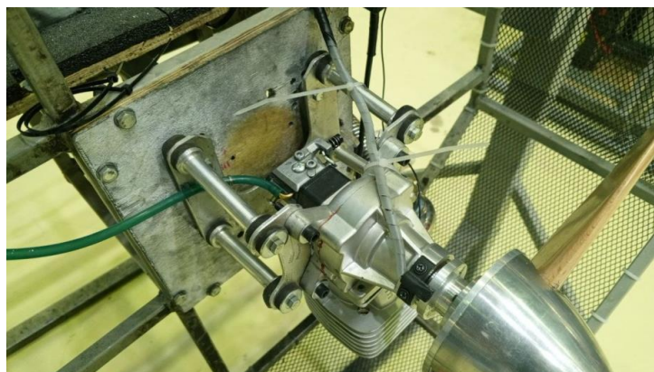
Рисунок 9 – Размещение двигателя на стенде цилиндром вниз с закреплением через моторную раму (третья серия экспериментов на стенде)
