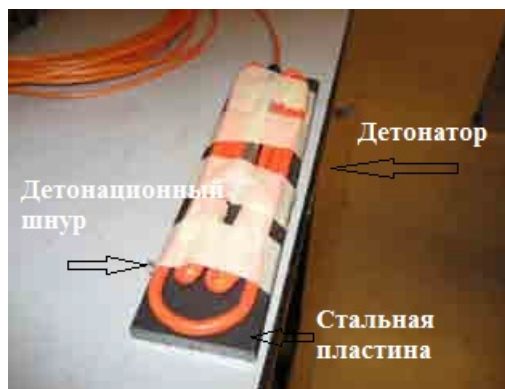
Рисунок 1.4.1 – Средство нагружения с детонационным шнуром
