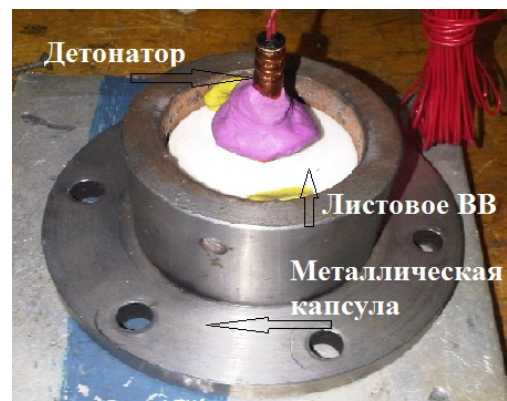
Рисунок 1.4.2 – Средство нагружения с листовым (пластическим) взрывчатым веществом
