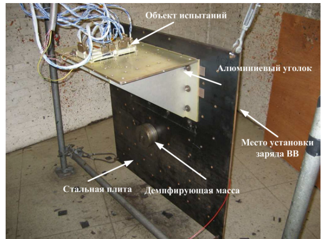
Рисунок 1.4.5 – Ударный стенд взрывного типа, вариант 2
