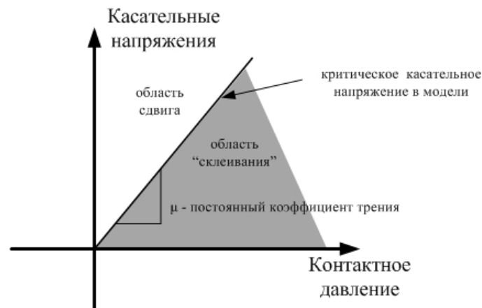
Рисунок 5.3.6 – Области сдвига/«склеивания» для модели кулоновского трения
