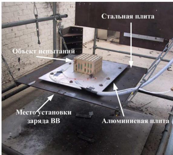
Рисунок 1.4.4 – Ударный стенд взрывного типа, вариант 1
