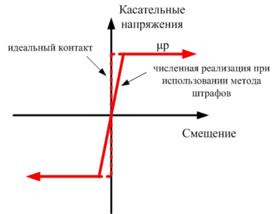
Рисунок 5.3.5 – Свойства контакта в касательном направлении к контактирующим поверхностям
