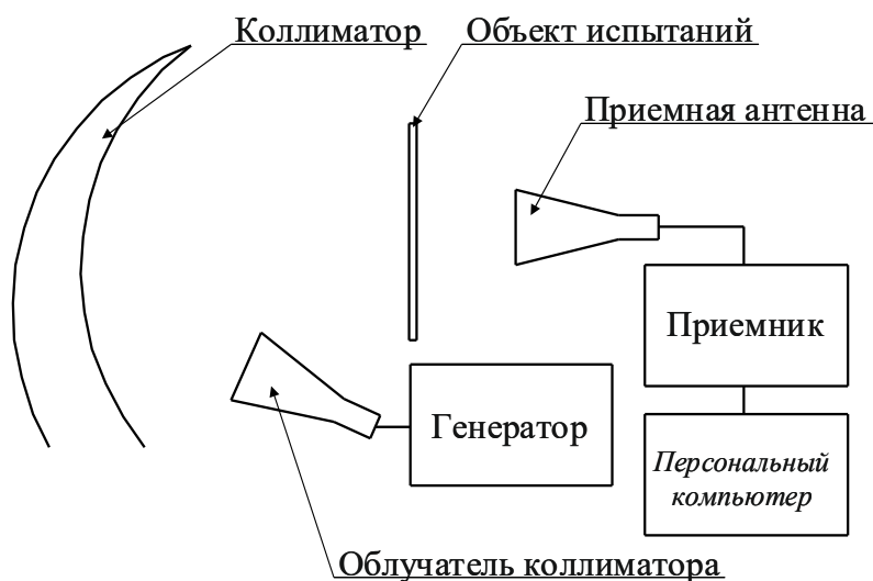
Рисунок 2.6 — Схема рабочего места в БЭК с коллиматором
