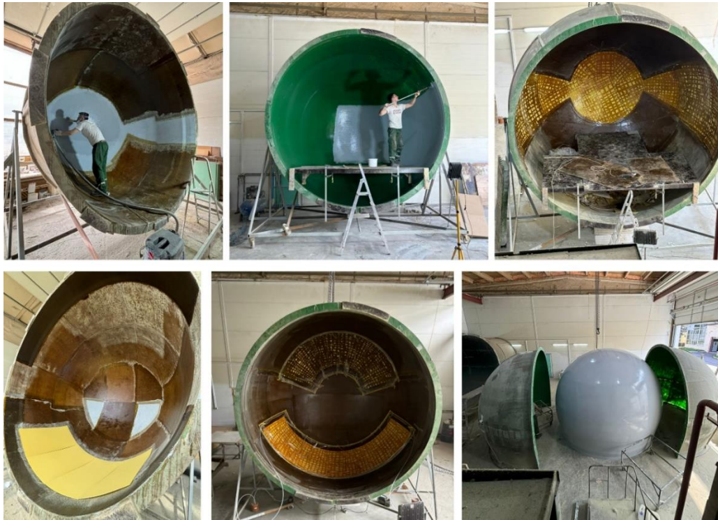
Рисунок 1.2 — Этапы технологического процесса изготовления крупногабаритных РПУ
