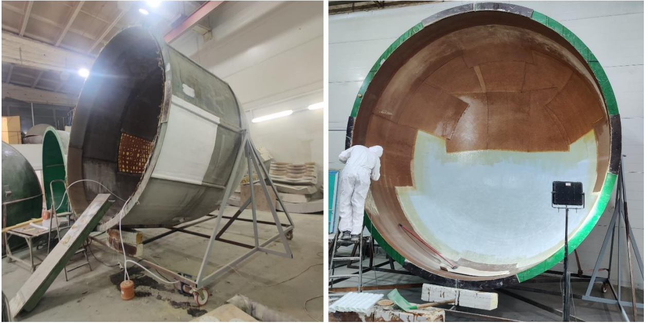
Рисунок 4.15 — Матрица для изготовления обтекателей
