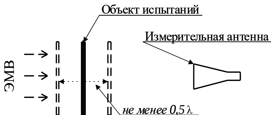
Рисунок 2.8 — Расположение обтекателя в процессе измерения
