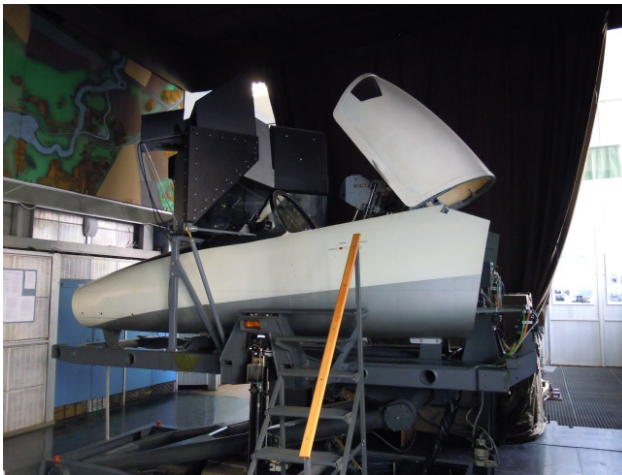
Рисунок 1.6 – Пилотажный стенд ТЛ–39
