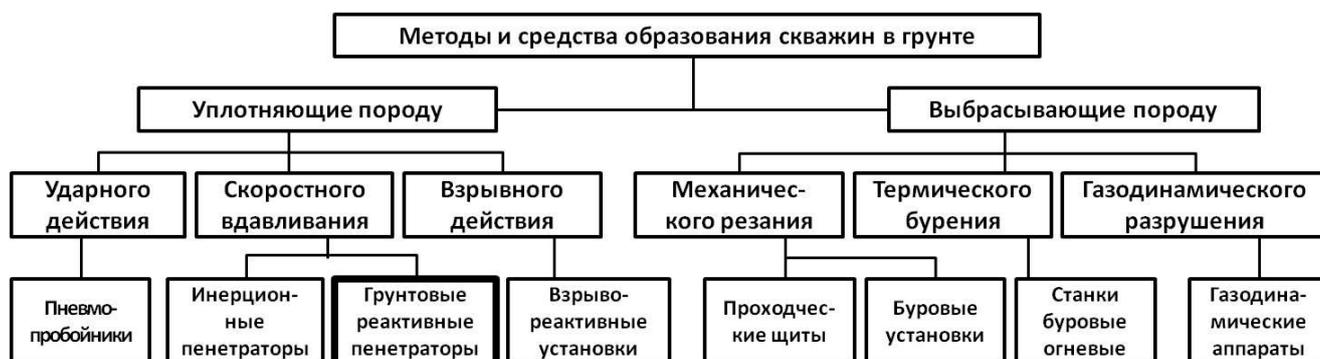
Рис. 1. Классификация методов и средств образования скважин в грунте
