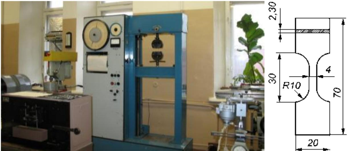
Рисунок 2.17 – Разрывная машина Р0.5, которая использовалась для определения прочности сварных швов
