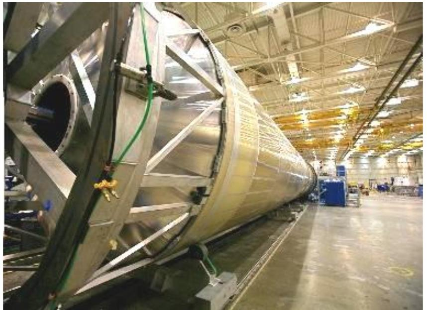
Рисунок 1.13 – Бак ракеты-носителя Falcon 9 из алюминий-литиевого сплава: сварка трением всех продольных и круговых швов
