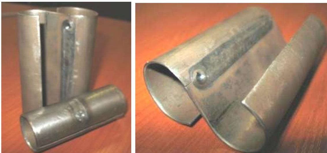
Рисунок 2.34 – Образец из конструкционной стали, изогнутый после сварки трением
