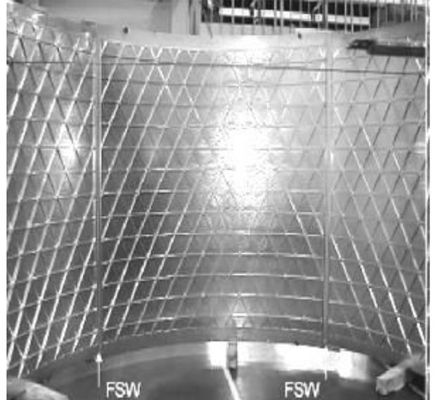
Рисунок 1.16 – Перемешивающая сварка трением при изготовлении сегментов топливного бака ракеты-носителя Н-ПВ
