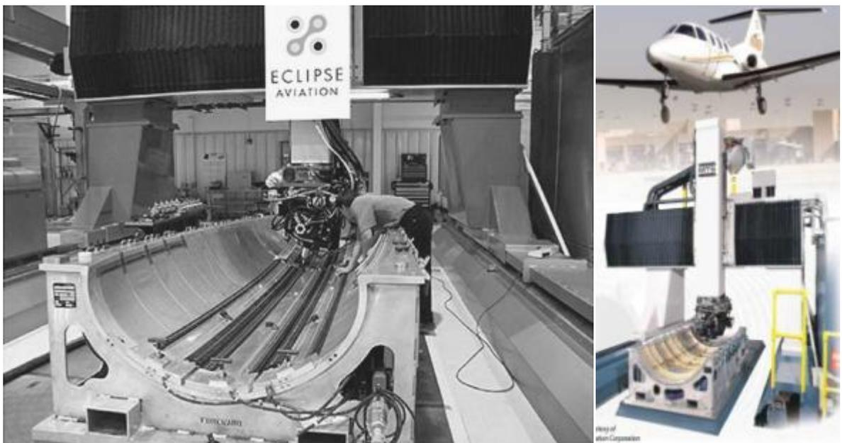
Рисунок 1.11 – Оборудование СТП используемое при сборке самолёта Eclipse 500, изготовленное MTS Systems Corporation
