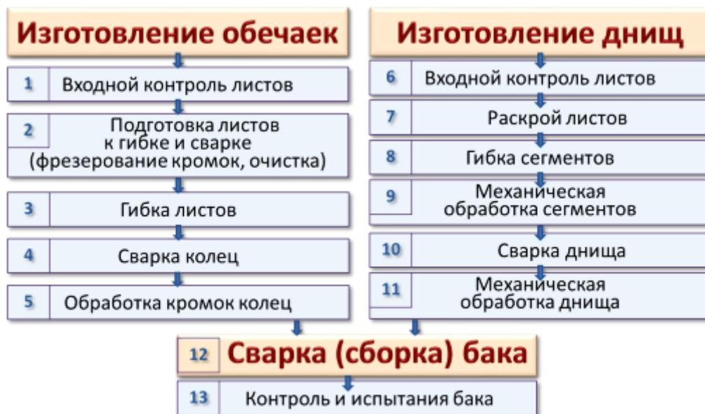
Рисунок 4.27 – Этапы технологического процесса изготовления топливных баков
