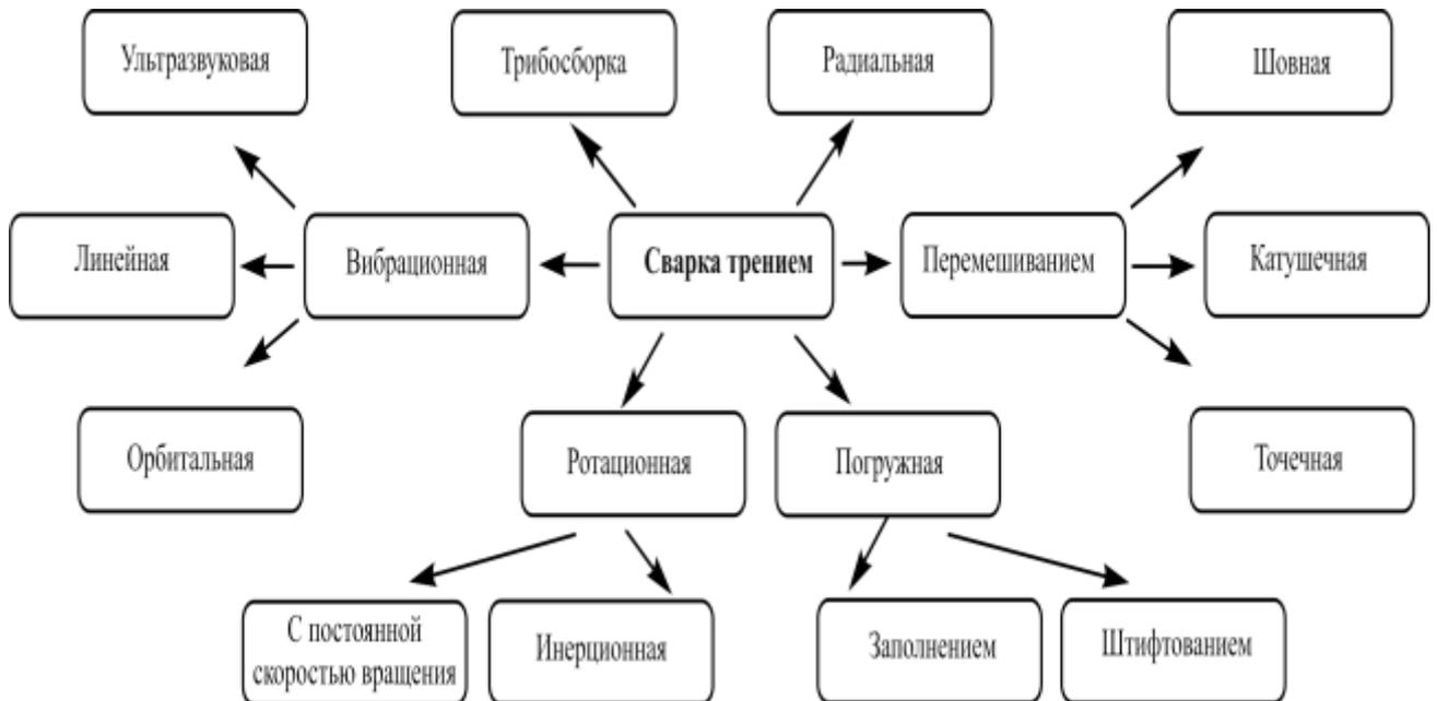
Рисунок 1.3 – Процессы сварки трением
