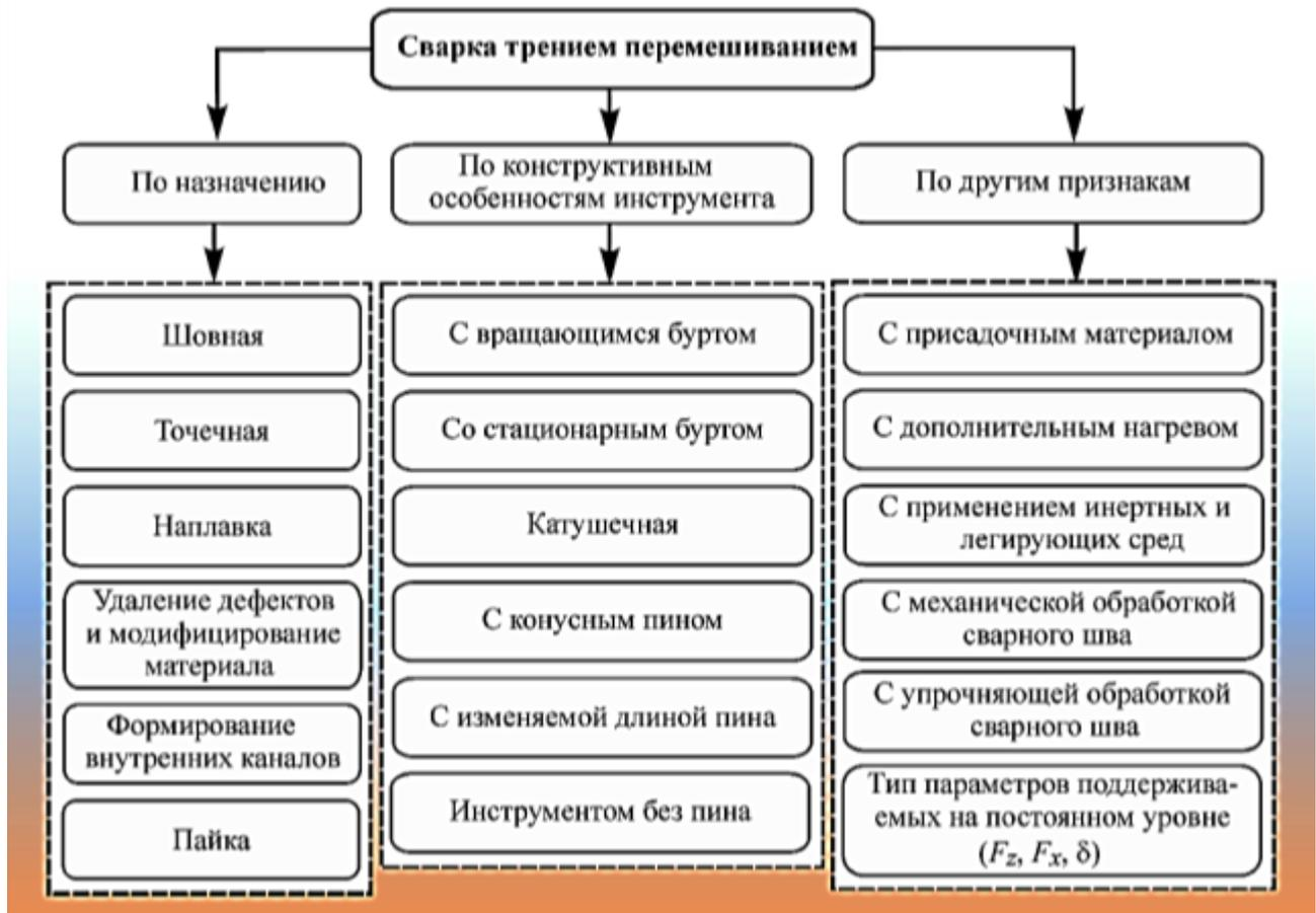
Рисунок 1.4 – Классификация сварки трением с перемешиванием
