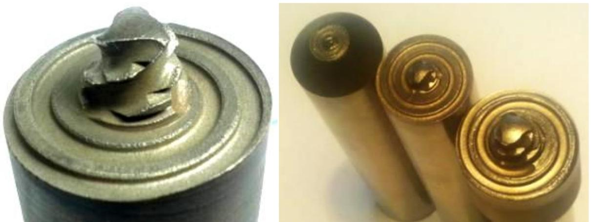
Рисунок 3.11 – Опытные образцы инструмента СТП с рабочей частью спиралевидной формы
