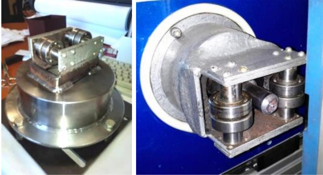
Рисунок 4.8 – Прижимной узел заготовок установки СТП
