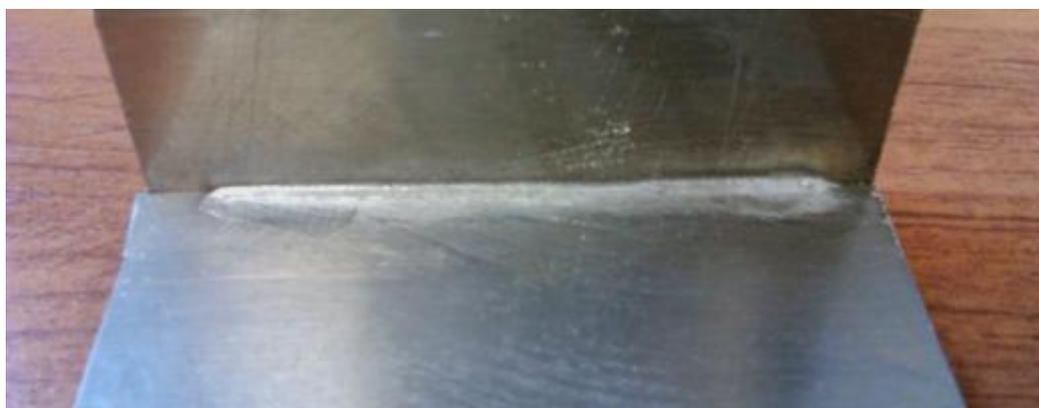
Рисунок 4.18 – Обратная сторона сварного шва
