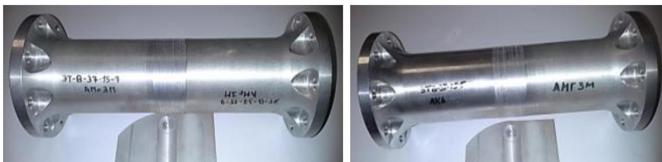
Рисунок 4.26 – Элементы фланцев редуктора несущего винта вертолета, полученные СТП
