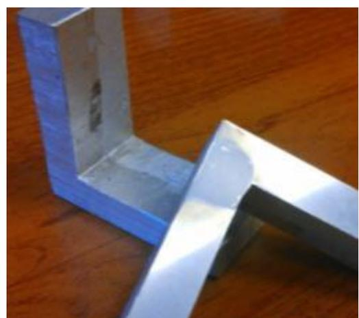
Рисунок 4.16 – Качественные угловые швы. Сплав Д16АМ
