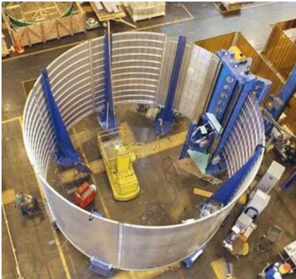
Рисунок 1.15 – Перемешивающая сварка трением на фирме Boeing: сегмент топливного бака
