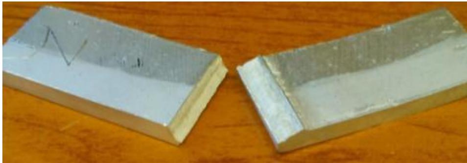
Рисунок 4.14. – Характерное разрушение углового шва при изгибе
