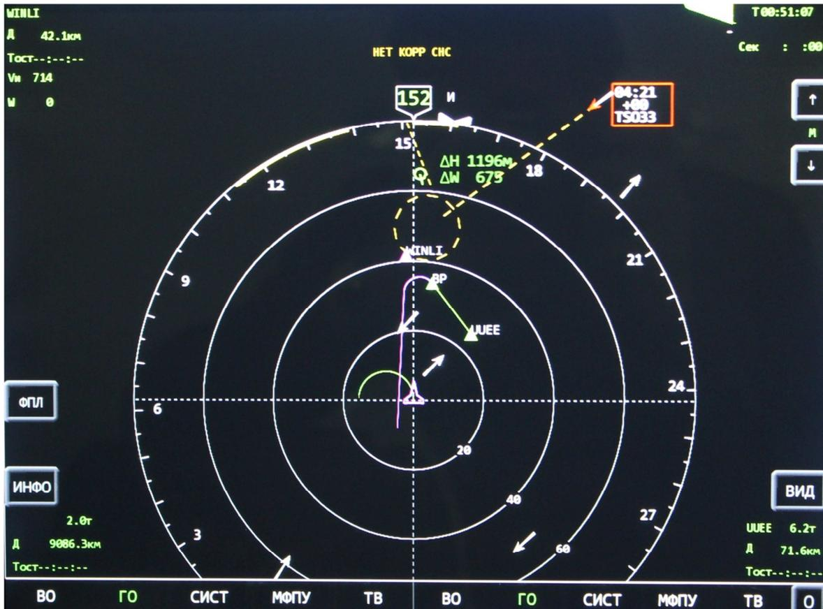
Рисунок 27. Модель навигационного дисплея кабины
