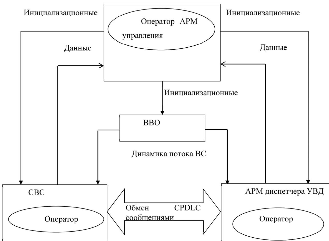
Рисунок 29. Конфигурация программных модулей КИС УВД для проведения исследований процедуры АСМ
