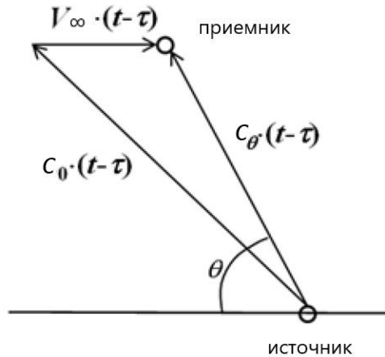
Рисунок 35 – Схема влияния конвекции на расчет времени запаздывания
