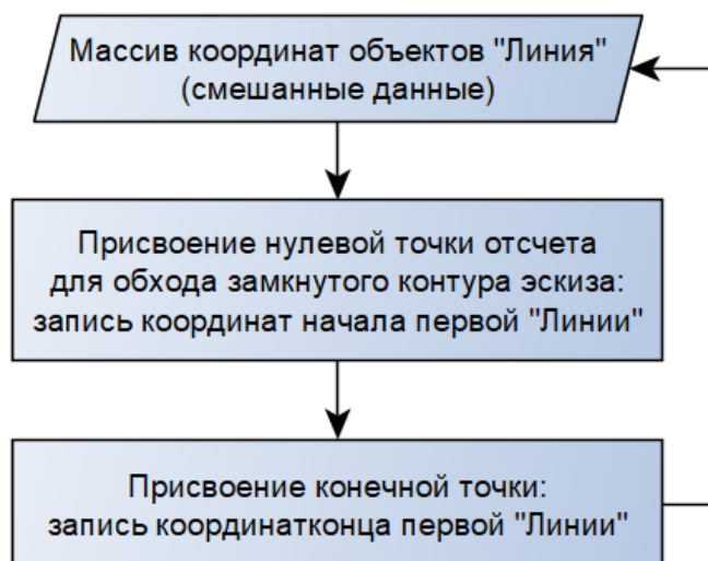
Рисунок 3.12 – Алгоритм функции послойного сглаживания слоев модели сегмент №4
