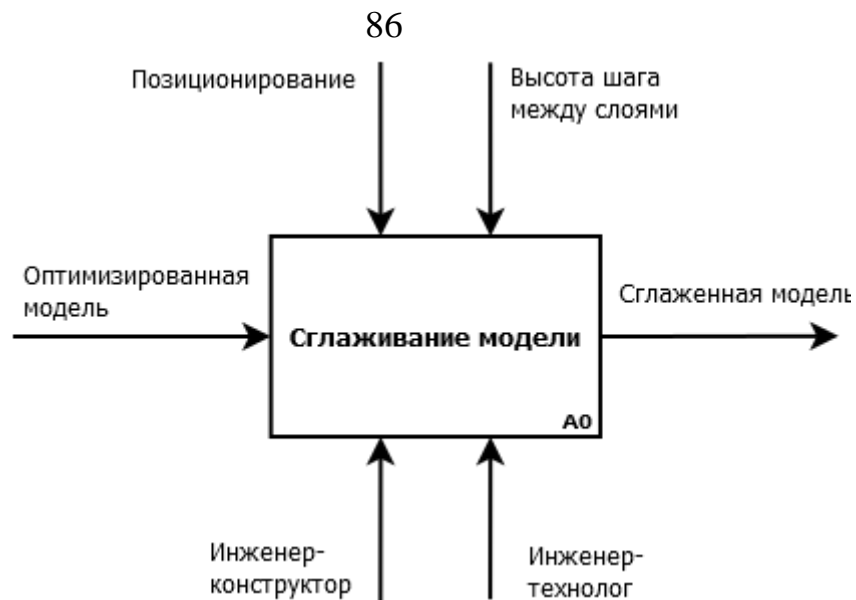
Рисунок 3.2 – Описание функциональной модели верхнего уровня
