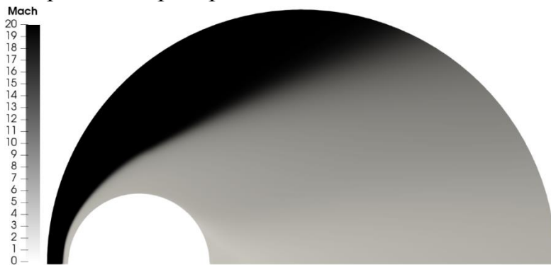
Рисунок 6. Поле числа Маха для расчетного режима M=19,99
