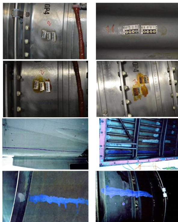
Рис. 5. Примеры расположения термоиндикаторов «ИНТЕМ» и нанесения термокраски на поверхностях двигателей
