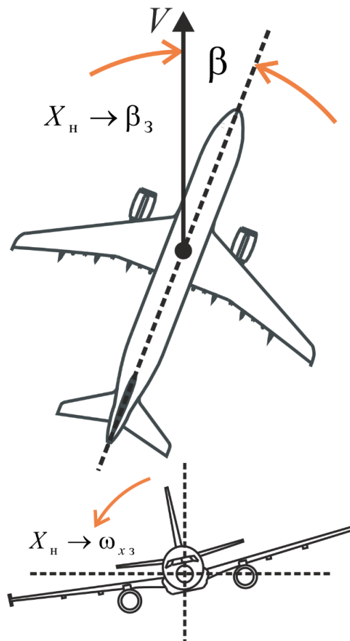
Рисунок 4.11 – Концепция управления в путевом канале
