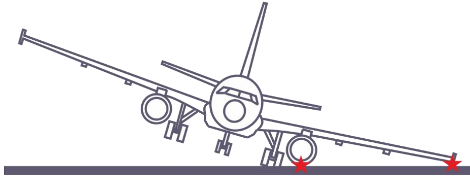
Рисунок 3.1 – Геометрическое ограничение при движении по ВПП
