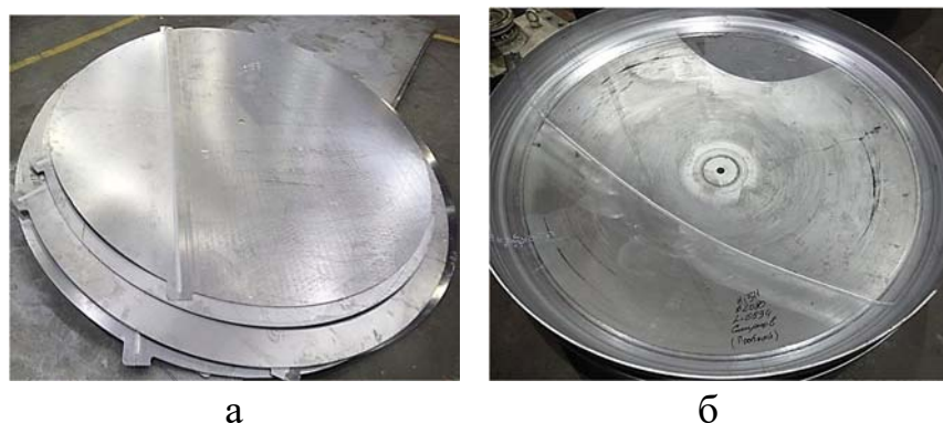
Рисунок 4 – Сварные заготовки (а) и днища котла бензовоза (б) после холодной деформации сварной заготовки из сплава 1565чМ толщиной 7 мм
