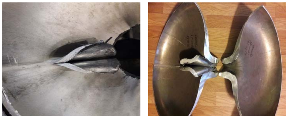
Рисунок 5 – Возникновение дефекта из-за склонности металла шва к сверхпластичности при осадке обечайки в нагретую форму
