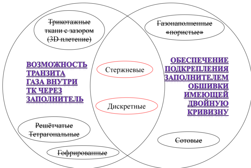
Рисунок 2 - Соответствие различных структур заполнителей трёхслойных конструкций требованиям, предъявляемым к облику ТНПсВУПС
