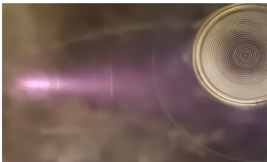
Рисунок 3.4 – Источник ионов КЛАН-53-3 в режиме извлечения ионного пучка с током 2 мА
