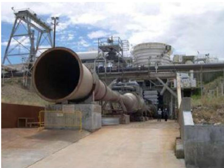
*Рисунок 2. Фотография последней ступени газ-газового эжектора на стенде фирмы Honeywell.*
