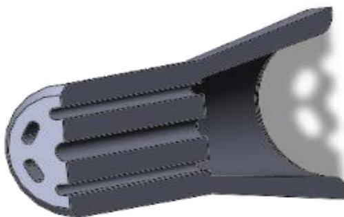
*Рисунок 28. 3D модель струйной форсунки с семью отверстиями.*
