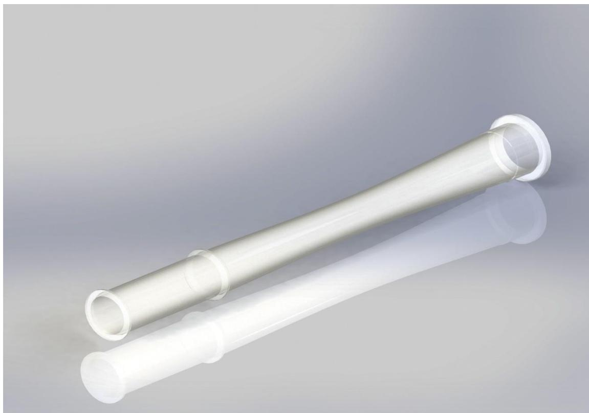
*Рисунок 12. 3D модель сопла двухфазного жидкостно-газового эжектора*
