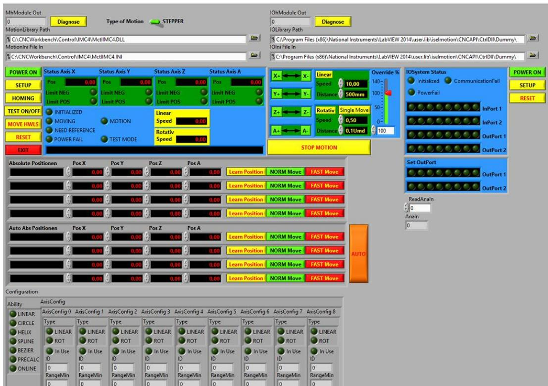
Рисунок 23. Лицевая панель программы управления положением объекта исследования
