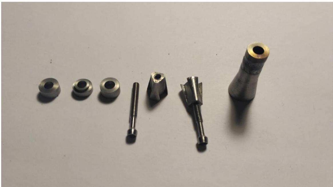
*Рисунок 32. Фотография составных частей струйной форсунки с регулируемым расходом*
