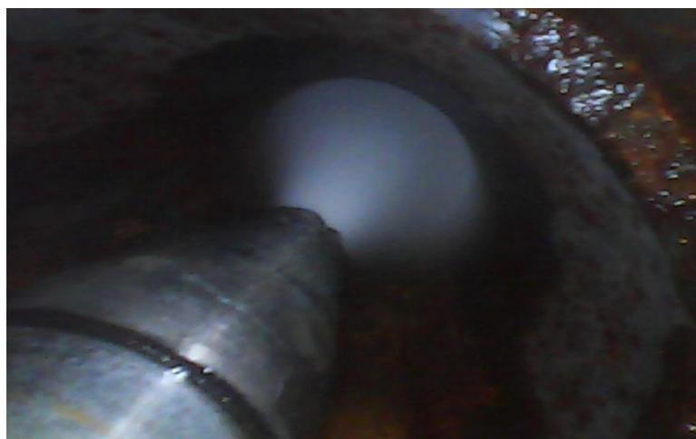
*Рисунок 49. Фотография работы форсунки в ЖГСА выполненная видеоэндоскопом.*
