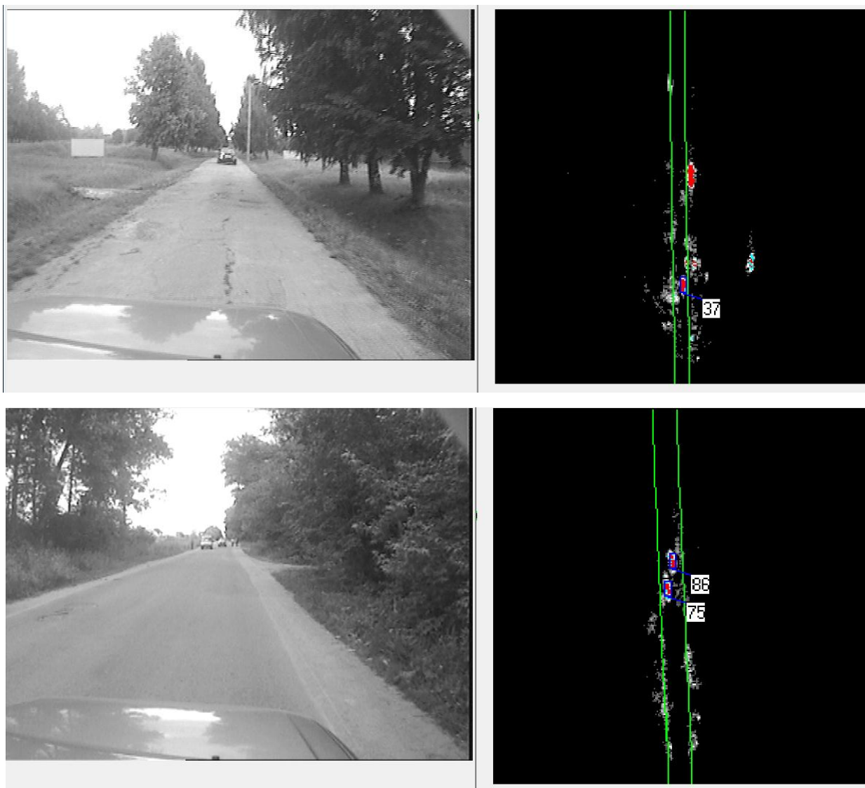
Рисунок 4.10. Определение дальности до автомобиля в пределах КБ
