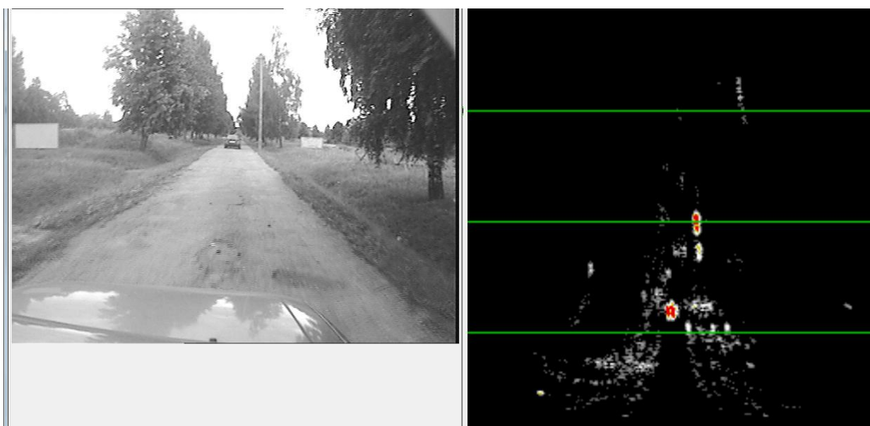
Рисунок 2.6. Радиолокационное и оптическое изображение однополосной асфальтовой дороги
