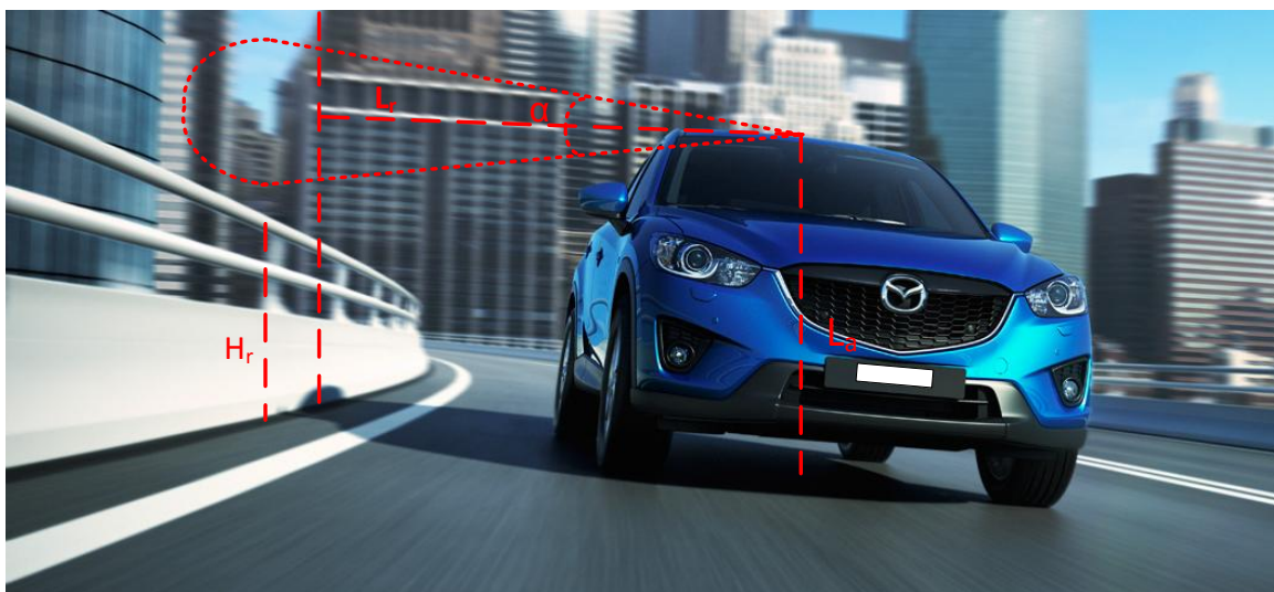
Рисунок 3.3. Взаиморасположение фазового центра антенны, автомобиля и границы дороги
