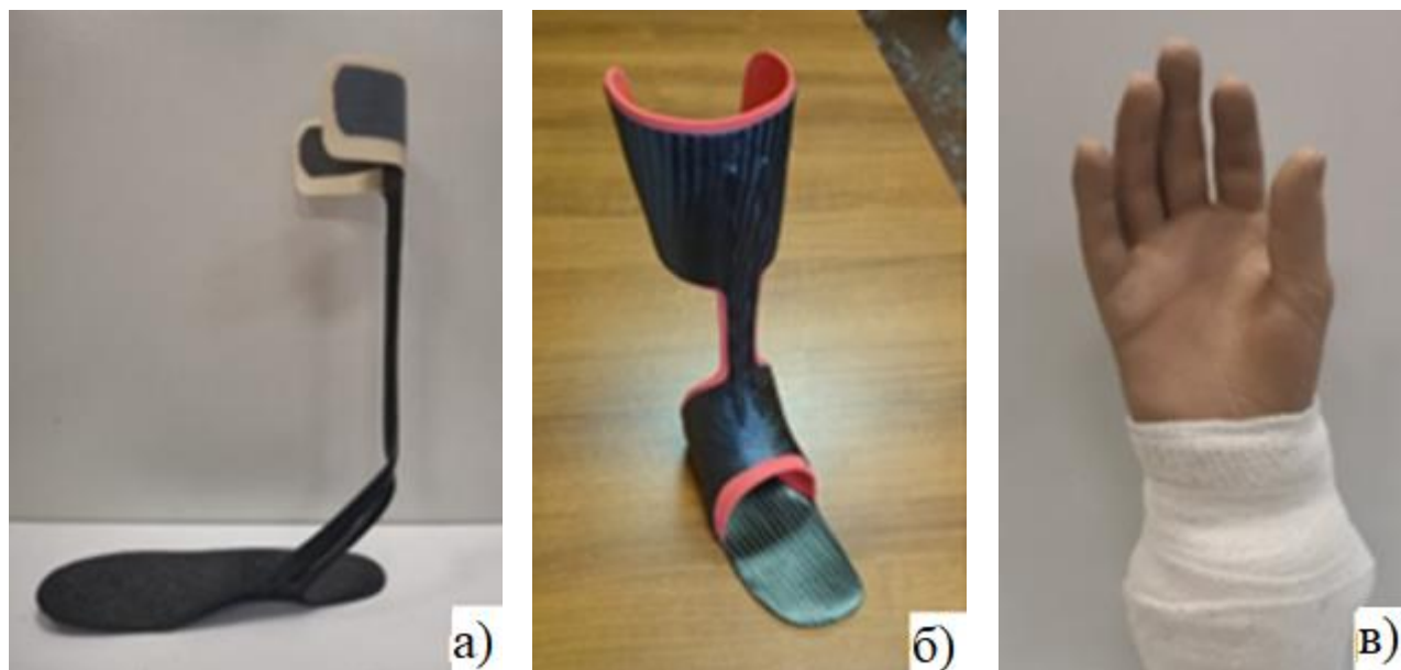
Рисунок 7 – Макеты стоподержателя из армированного углепластика (а – с изогнутым упругим элементом; б – с прямым упругим элементом) и макет протеза руки из ФКМ «силиконовая резина – никелид титана» с ЭЗФ (в).
