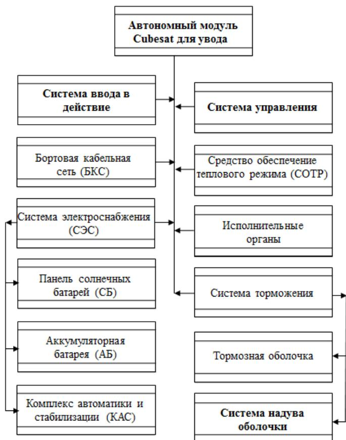
Рисунок 4. Декомпозиция автономного модуля увода КА Cubesat
