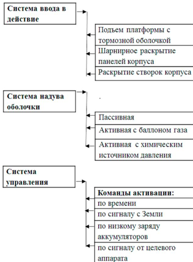
Рисунок 5. Варианты реализации основных подсистем для увода КА Cubesat
