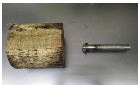
б) Втулка с деревянной проставкой
