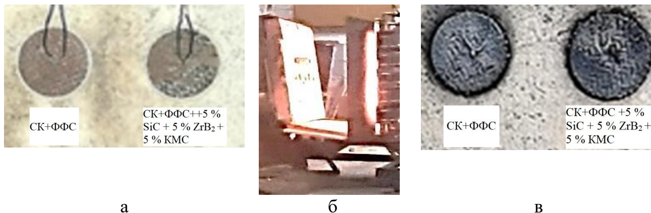
Рисунок 74 – Фотографии образцов а) до испытания; б) во время испытания; в) после испытания
