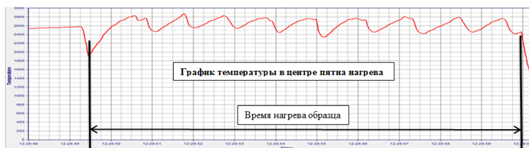
Рисунок 66 – График температуры в центре пятна нагрева на внешней стороне образцов
