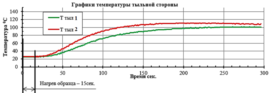
Рисунок 73 – Графики температуры тыльной стороны образцов
