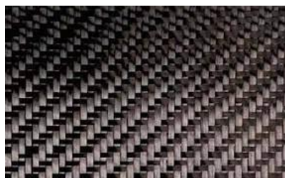
Рисунок 16 – Углеродная ткань марки UWB-3K-TWILL2/2-100
