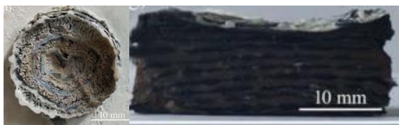
Рисунок 7 – Структура ПКМ на основе СК после высокотемпературного воздействия [132]
