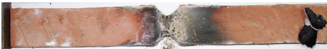
Рисунок 78 – Образцы с матрицей из смеси СК и ФФС после испытаний
