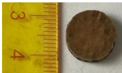
Рисунок 24 - Образец для измерения температуропроводности
