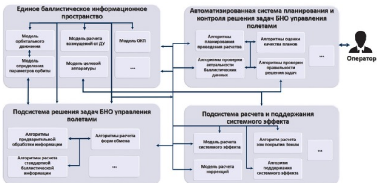
Рисунок 3.12 – Схема взаимосвязей моделей БНО управления многоспутниковыми КС ДЗЗ.
