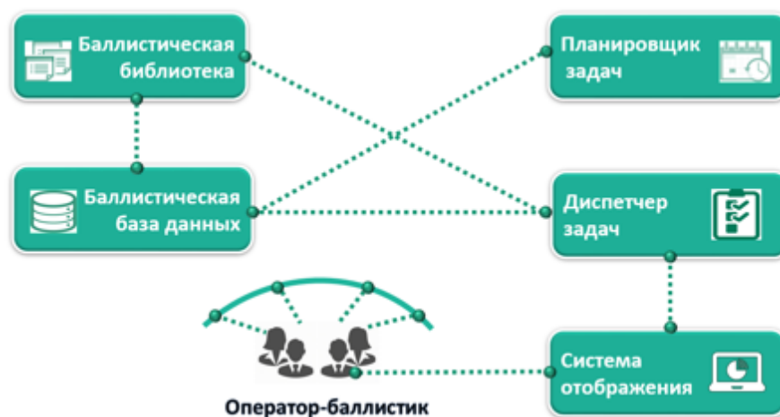
Рисунок 5.16 – Структура системы планирования
