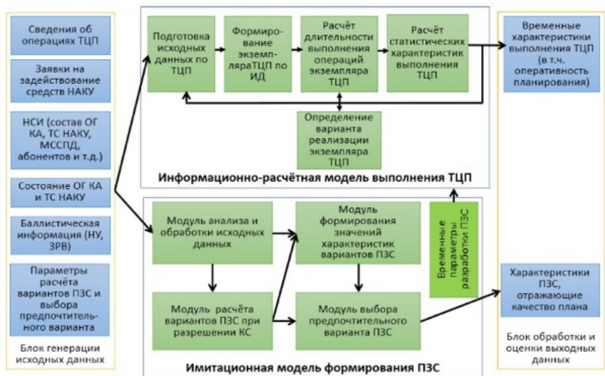
Рисунок 3.4 – Модели оценки характеристик оперативности планирования и качества плана выполнения задач БНО управления полетами
