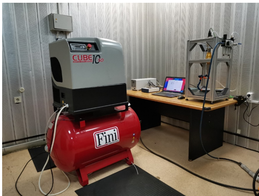
Рисунок 2.11. Внешний вид пьезоэлектрической усталостной машины
