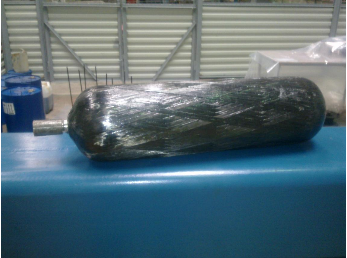
Рис. 5.5.1. Баллон БК-8 до испытаний на разрушение
