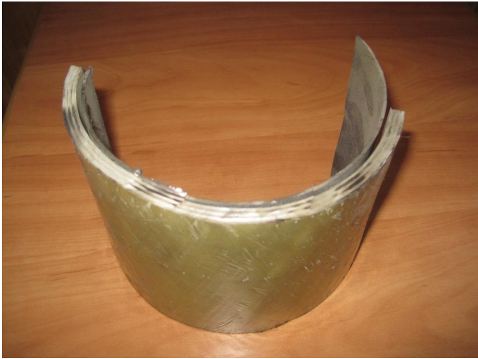
Рис. 5.6.1 Конструктивный элемент, вырезанный из стенки комбинированного (металл-стеклопластик) баллона высокого давления P_{раб}=29,4 МПа, вес 6,0кг
