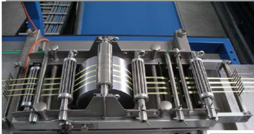
Рис. 2.5.7 Конструктивная схема пропитки с прижимными роликами
