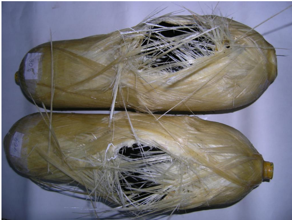
Рис. 5.4.2. Баллон БК-7 после испытаний на разрушение
