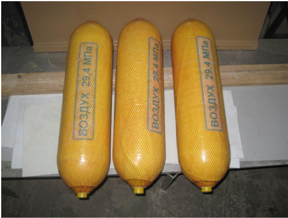
Рис. 5.4.1. Баллон БК-7 до испытаний на разрушение
