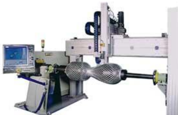
Рис. 2.5.2 Намоточный станок с вынесенным приводом вращения и стойкой закрепления оправки
