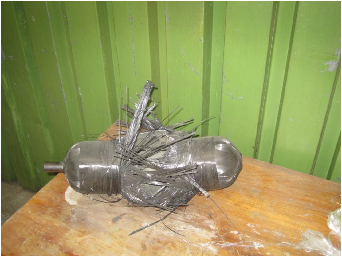
Рис. 5.5.2. Баллон БК-8 после испытаний на разрушение
