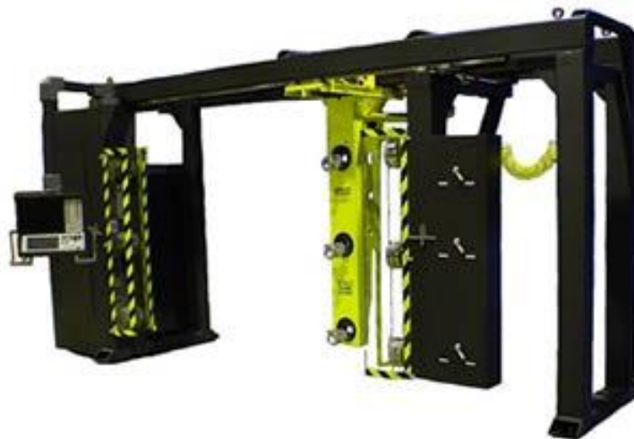
Рис. 2.5.4 Трех шпиндельный намоточный станок рамного типа
