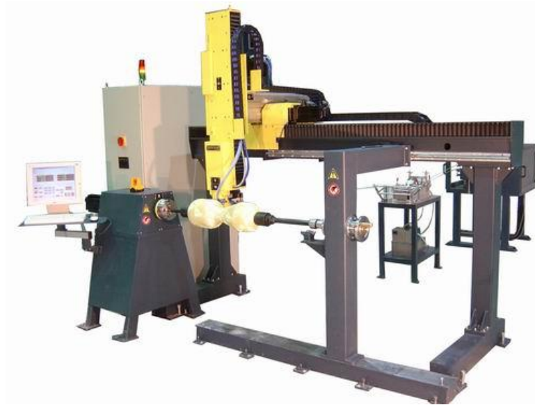
Рис. 2.5.3 Намоточный станок с вынесенным приводом вращения и единой стойкой закрепления оправки
