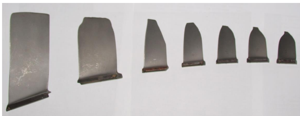
Рисунок 1.9 – Характер предельного износа рабочих лопаток ГСВ по ступеням 2 по 8 (наработка 128 часов)
