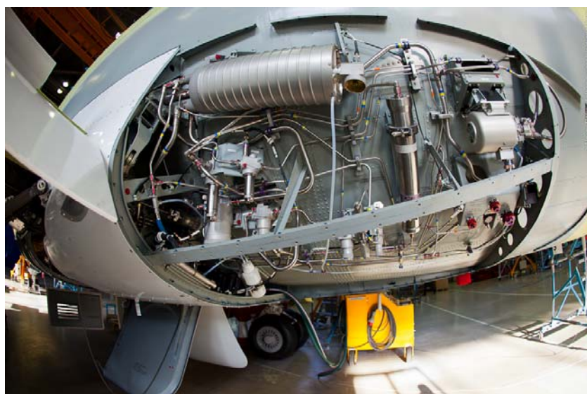
Рисунок 2.7 – Гидросистема самолета “Сухой Суперджет 100”
