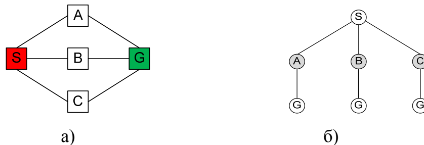
Рисунок 3.2 Иллюстрация прохождения точек маршрута в пространстве и соответствующее ей дерево поиска от начальной точки ( S ) к целевой точки ( G ) при поиске в ширину (а) и поиске в глубину (б)
