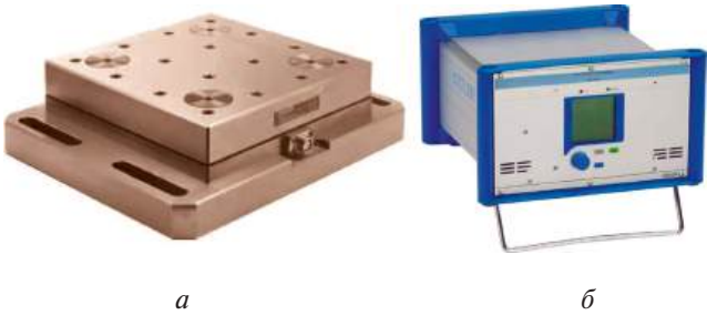
Рис. 1. Система измерения усилий: а – динамометрическая платформа; б – зарядовый усилитель
