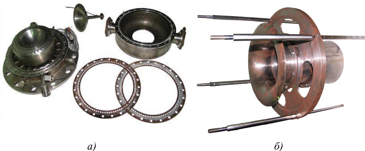
Рисунок 4– Исследуемый тяговый модуль (а) и эжекторный усилитель тяги (б)
