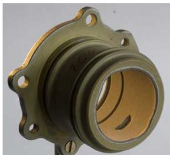
Рисунок 14 – Общий вид стакана подшипника с МДО покрытием
