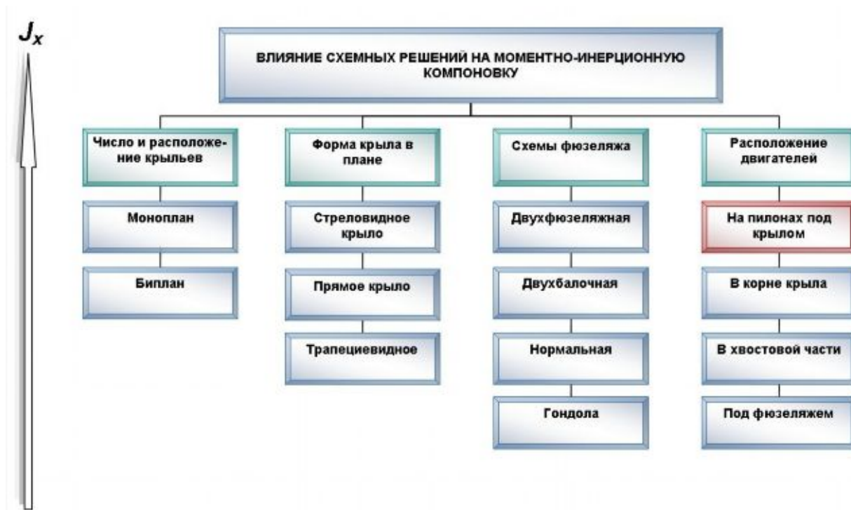
Рис. 3. Влияние схемных решений на моментно-инерционную компоновку относительно оси ОХ
