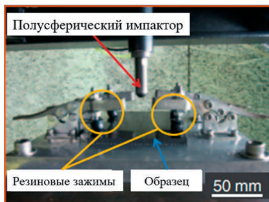
Рис. 5. Фрагмент испытательной машины с установленным образцом
