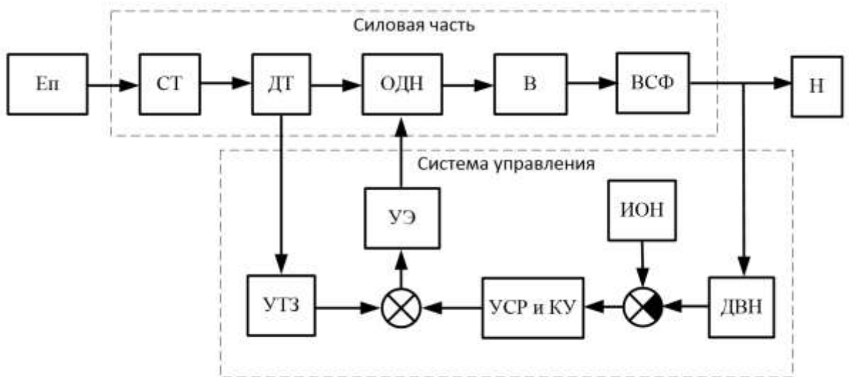
Рис. 2.1. Обобщенная функциональная схема РВУ на базе ОДН
