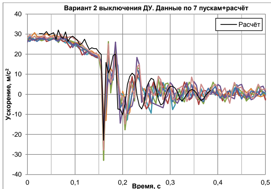
Рисунок 4.31 – Расчётные осевые ускорения в ПрО и данные ТМИ при пусках транспортных кораблей. Вариант 2 выключения ДУ
