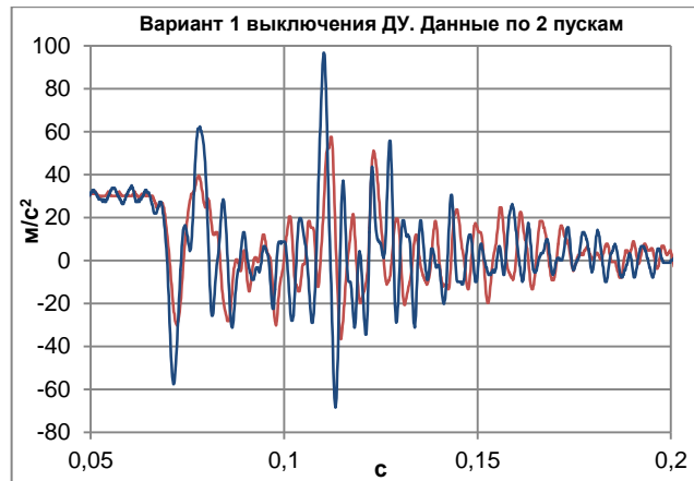
Рисунок 4.13 – Осевые перегрузки вблизи интерфейса ПГ типа транспортных кораблей с РН при спаде тяги ДУ в варианте 1 (более резком)
