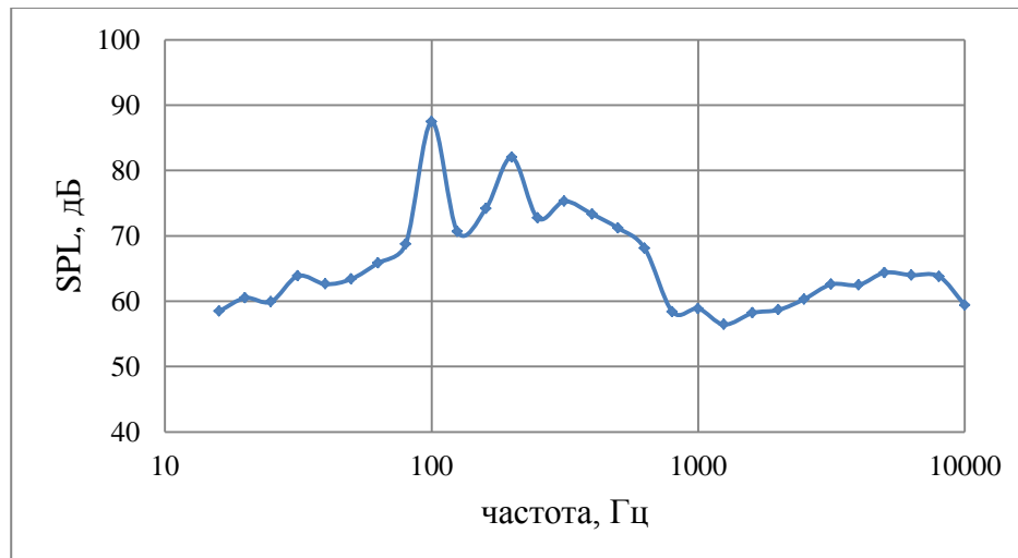
Рисунок 2.18 – Третьооктавный спектр уровней звукового давления в диапазоне частот 16-10000Гц при работе СУ самолета в статических условиях (режим 5, \varphi=105^\circ )
