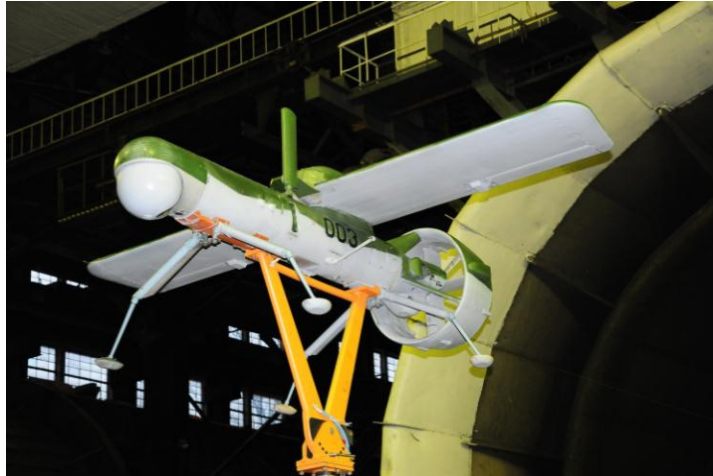
Рисунок 2.20 – Схема размещения БПЛА в рабочей части АДТ Т-104
