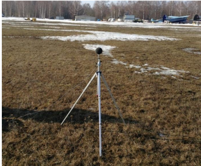
Рисунок 4.11 – Общий вид микрофона и поверхности промерзшей земли во время испытаний 11.03.2015
