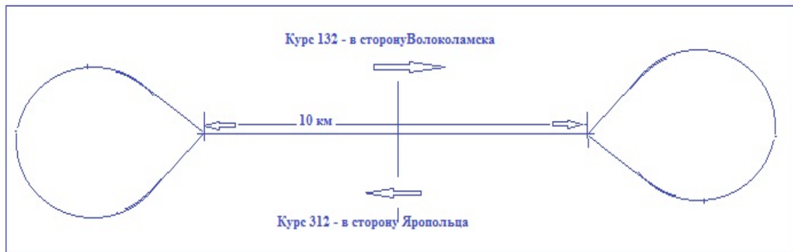
Рисунок 4.14 – Схема выполнения горизонтальных пролетов при акустических испытаниях
