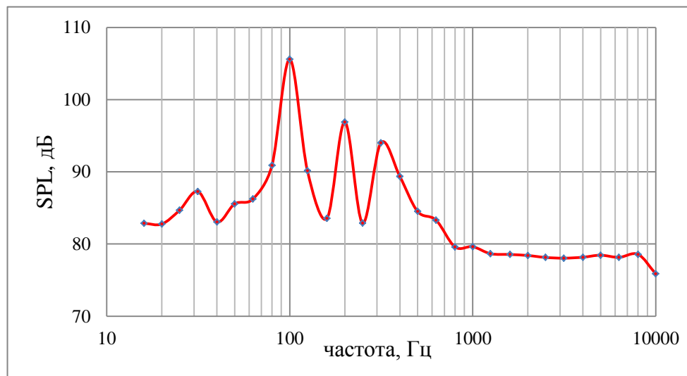
Рисунок 2.5 - Третьоктавный спектр акустического излучения силовой установки самолета Ан-2 в диапазоне частот 16-10000 Гц (Режим 6, \varphi=120^\circ )
