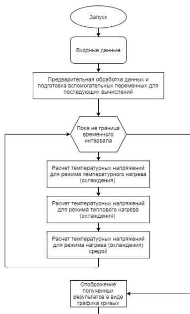
Рис.9 – блок-схема основного алгоритма комплекса программ.
