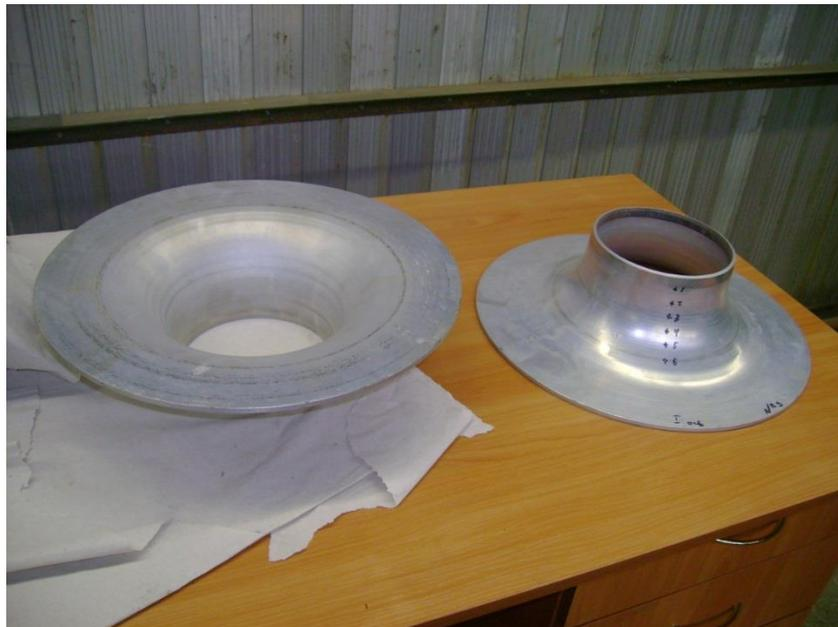
Рис.4.14. Фланцы из сплава 1201Т1
