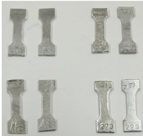
Рис.3.12. Образцы для проведения механических испытаний на растяжение
