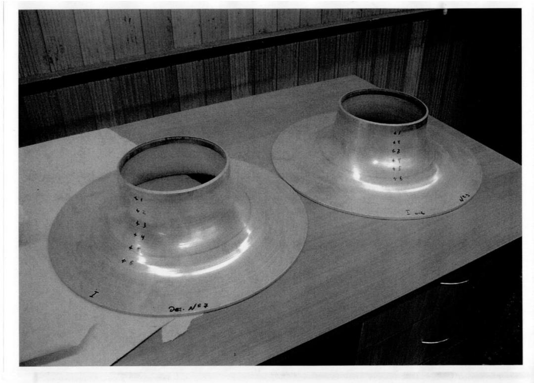
Рис.3.19. Фланцы из сплава 1201Т1
