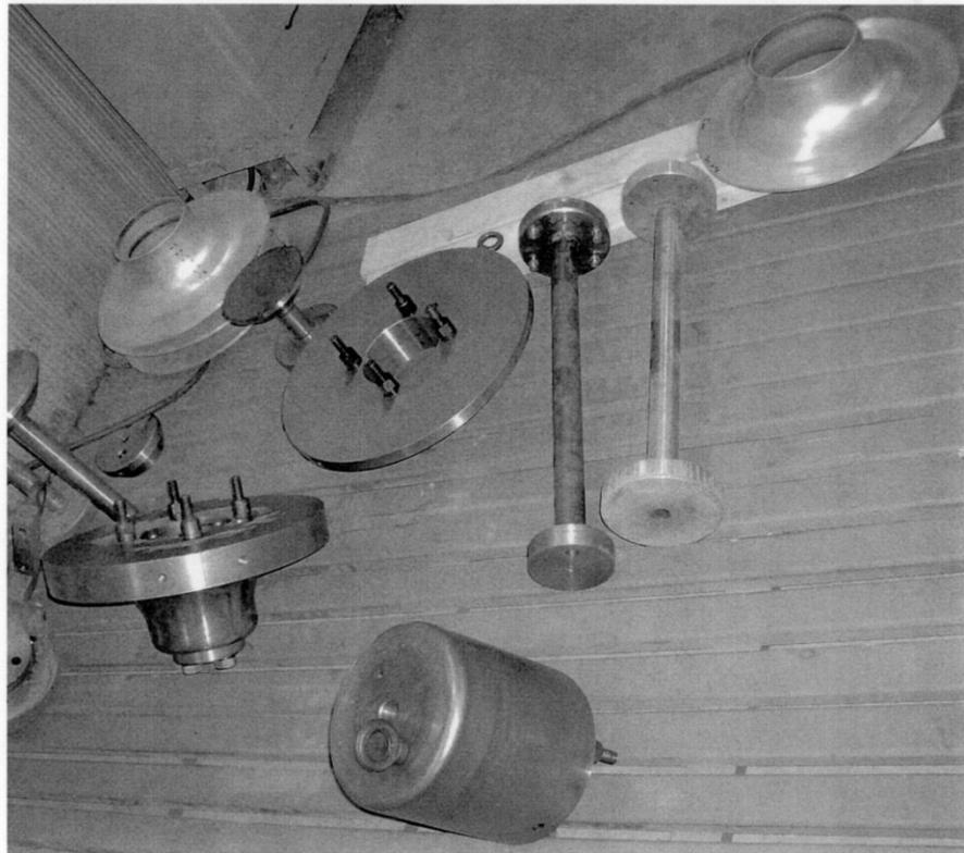
Рис.3.18. Технологическая оснастка для изготовления фланца
