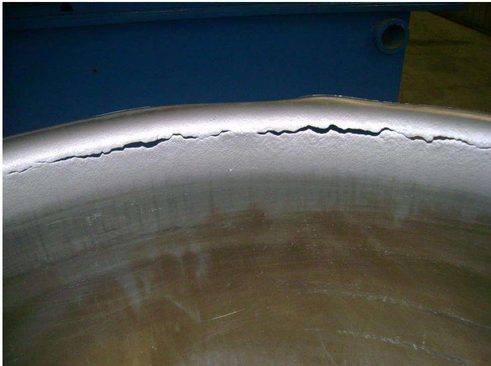
Рис.4.7. Трещины диафрагмы в зоне фланца
