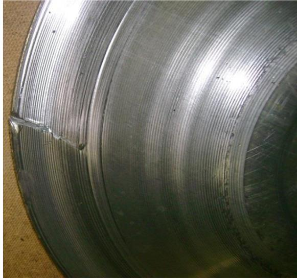
Рис.4.10. Трещина на краю фланца
