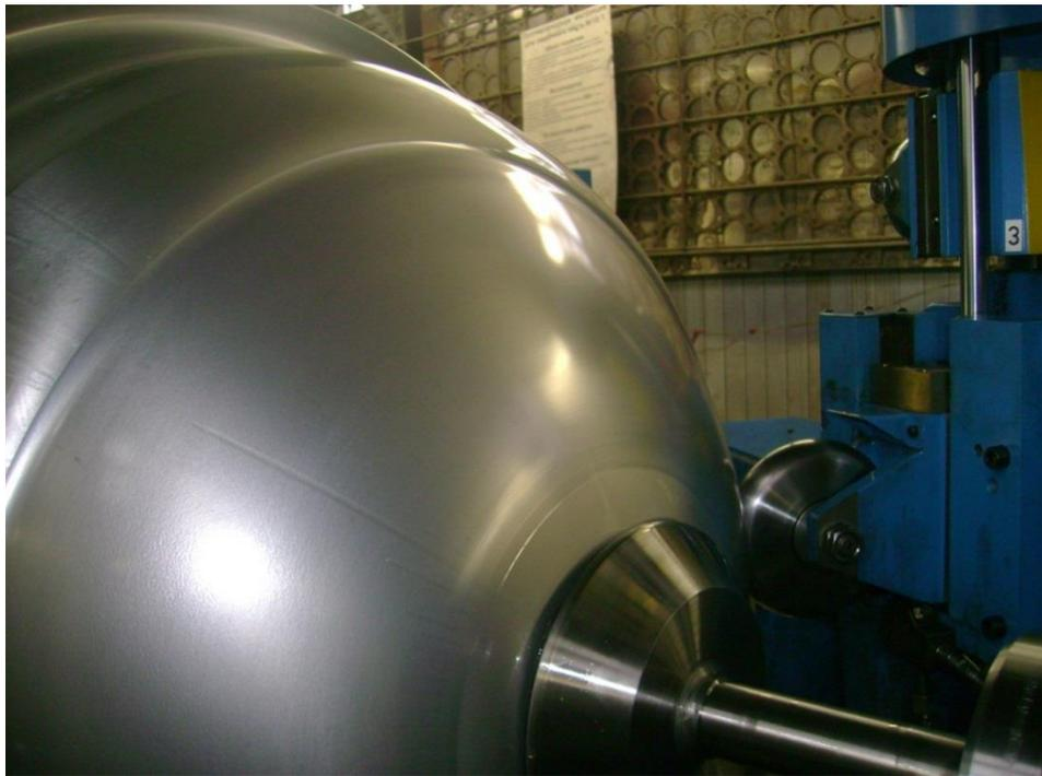
Рис.4.3. Диафрагма в процессе РВ
