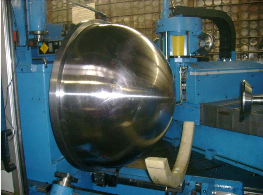
Рис.4.2. Оправка для РВ диафрагмы
