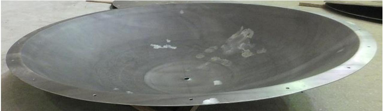
Рис.4.15. Обшивка днища  $\Phi$  3,0 м
