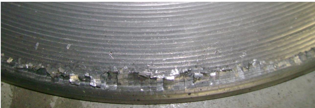
Рис.4.12. Отслоение металла на внешней поверхности фланца
