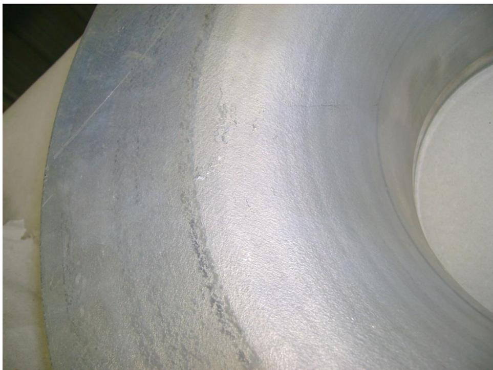
Рис.4.13. Шероховатость внутренней поверхности фланца
