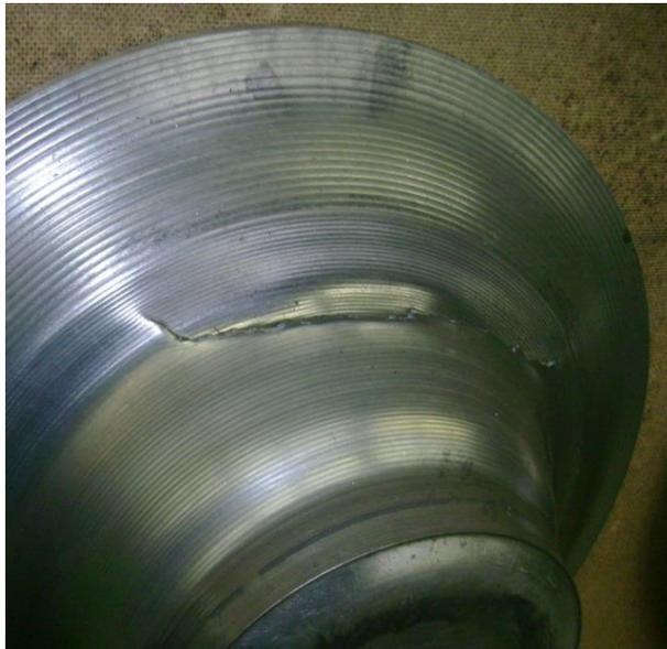
Рис.4.11. Трещина на радиусной части фланца
