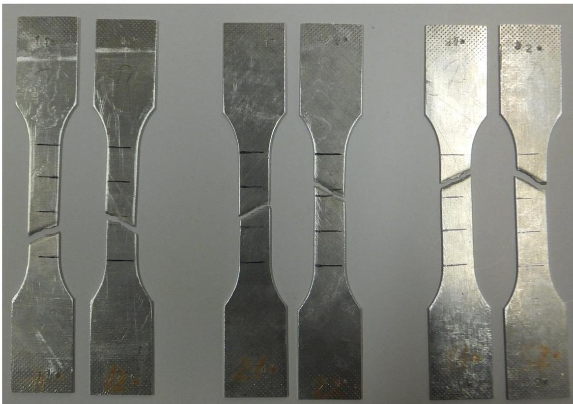
Рис.3.34. Образцы после испытаний листов на механические свойства
