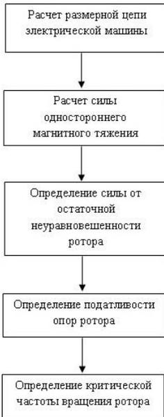
Рисунок 13 – Алгоритм расчета прочности роторов.
