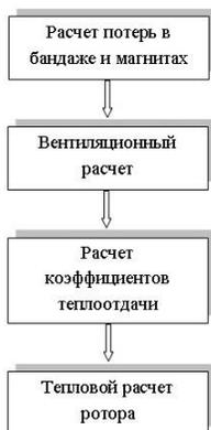
Рисунок 21 – Алгоритм теплового расчета ротора.
