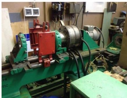
Рисунок 12 - Испытательный стенд для проверки механической прочности ротора.
