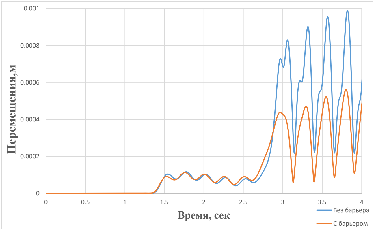
Рисунок 4.17. – Амплитуда перемещений точки на расстоянии \frac{l}{2} от барьера без барьера и после его установки ( \frac{h}{l} = 2.0, \frac{d}{h} = 0.1, \omega = 25.12 \text{ рад/с}, \gamma = 10^{-3} ).
