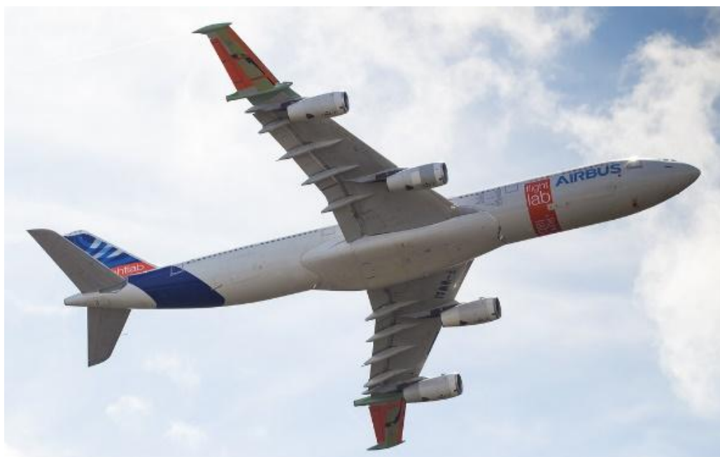
Рисунок 1.2 – Летящая лаборатория A330 европейского проекта BLADE с концевой частью крыла уменьшенной стреловидности и с ламинарным профилем
