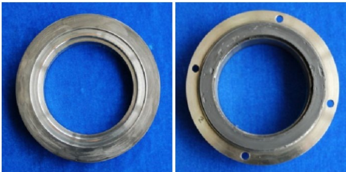
Рисунок 13 – Износ контактирующих торцовых поверхностей [84]
