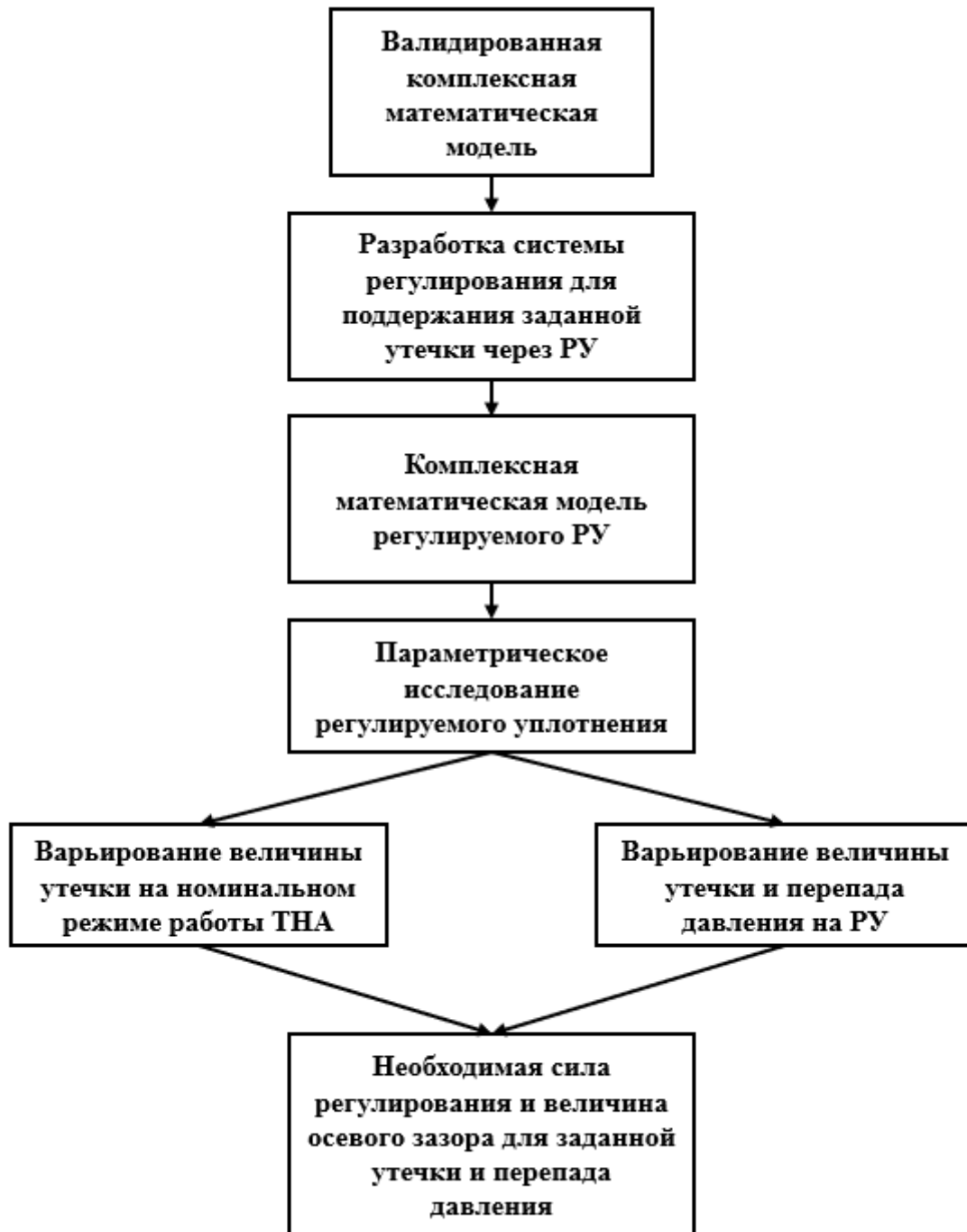
Рисунок 78 – Схема выполнения третьего этапа методики расчета РУ
