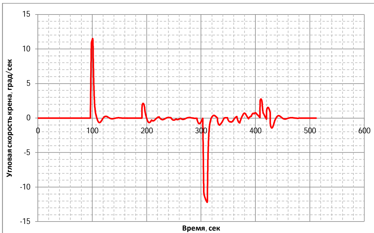
Рис. 4.1.5 Угловая скорость крена от времени для ТПК «Союз ТМА-М»
