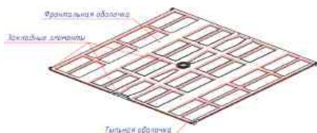
Рис. 1. Общий вид каркаса
