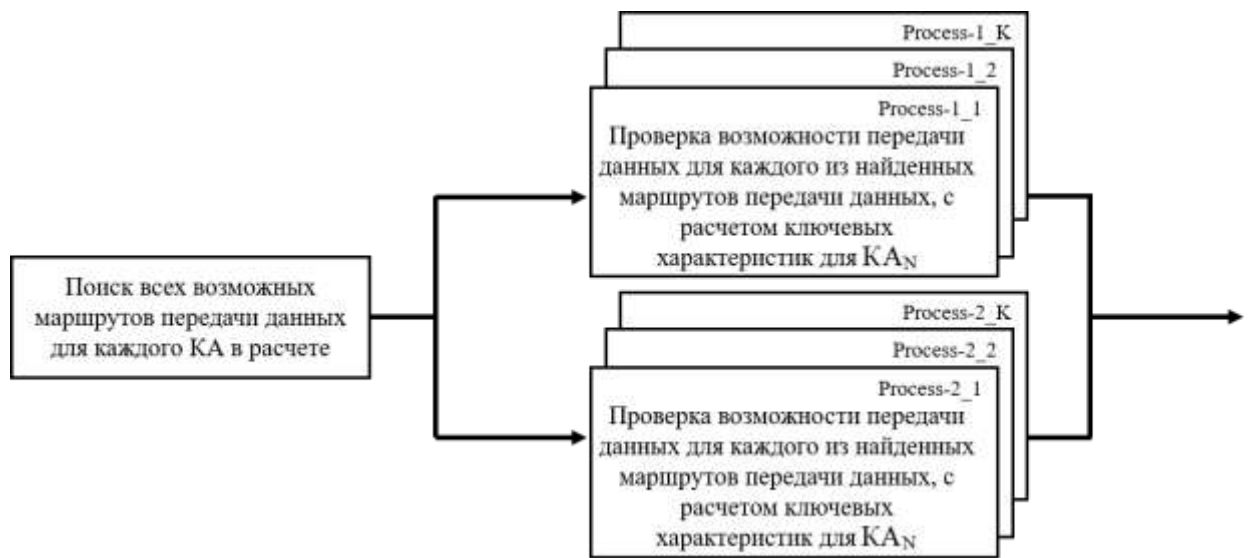
Рисунок 3.9 – Схема вложенной многопроцессорной обработки
