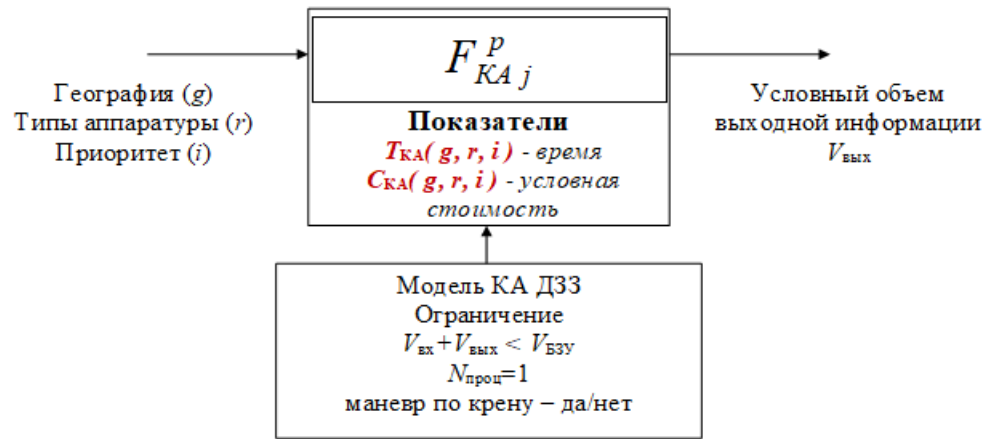
Рисунок 1.5 – Модель процесса обработки информации (космический сегмент)
