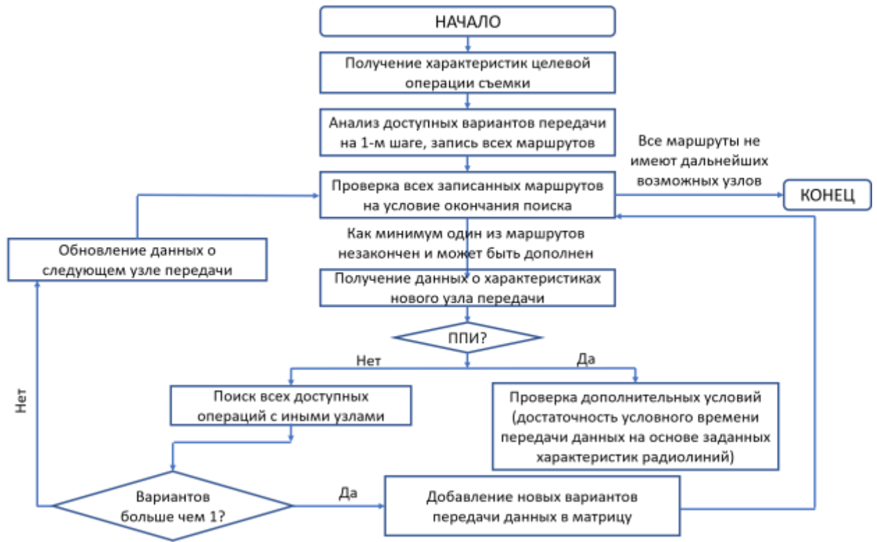
Рисунок 2.9 – Упрощенная блок-схема алгоритма маршрутизации
