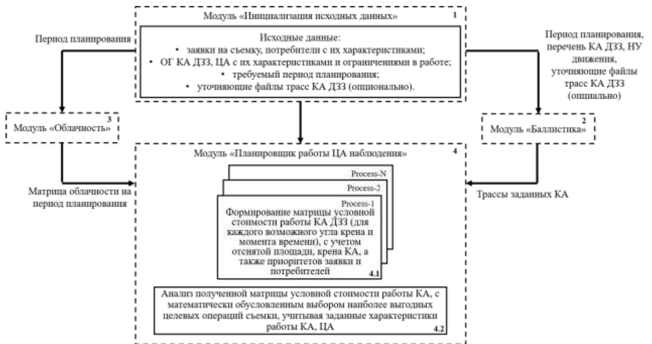
Рисунок 3.5 – Архитектура СПО планирования съемки ДЗЗ
