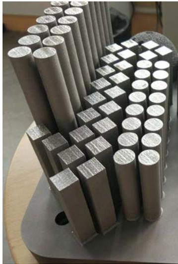
Рисунок 2.2 – Внешний вид образцов, напечатанных по методу СЛС
