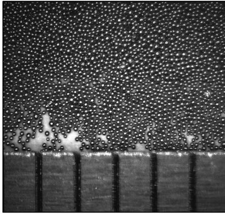
Рисунок 3.4 - Внешний вид гранул из титанового сплава ВТ6 для печати по технологии ПЛНМ (160+80 мкм)
