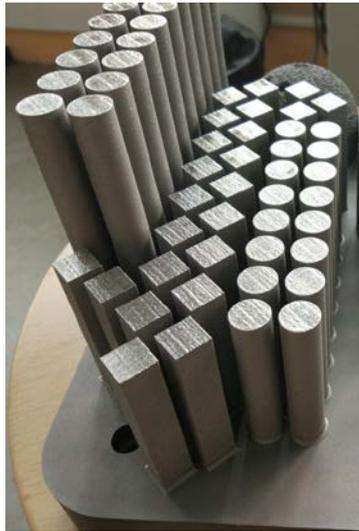
Рисунок 3.2 – Внешний вид образцов из сплава Ti-6Al-4V, изготовленных по 3D-технологии СЛС
