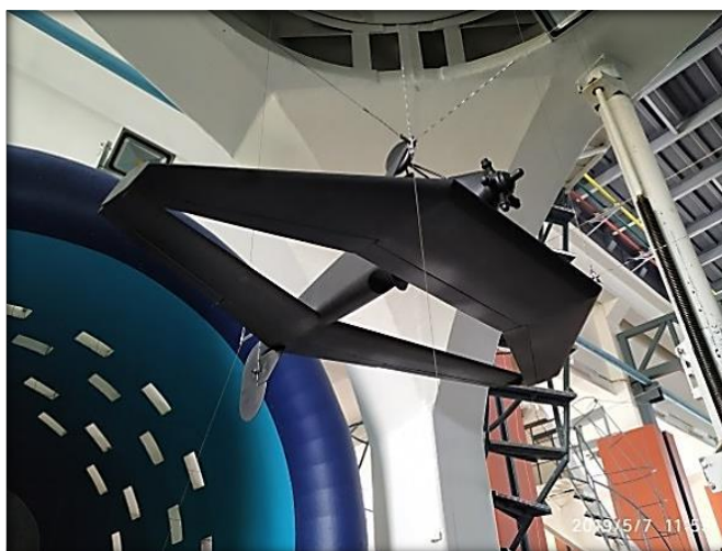
Рисунок 3 – Весовая модель самолета По-2 с модифицированным сочлененным крылом в аэродинамической трубе МАИ Т-1
