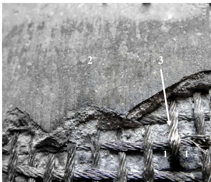
Рисунок 28 - Вид поверхности разрушения КМ, 1- «перемычки - мостики» между соседними матричными слоями, 2– внешний матричный слой, 3 – стальной трос.
