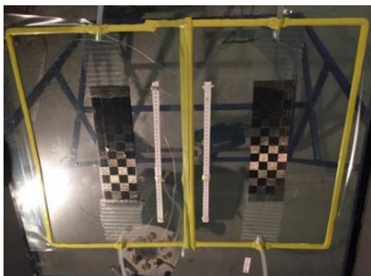
Рисунок 5 – Фото образцов ткани при определении значений коэффициента проницаемости недеформированного состояния
