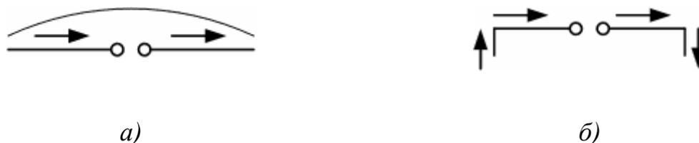
Рисунок 2.12 – Пояснения принципа уменьшения геометрических размеров при *L*-образной конфигурации вибратора.
