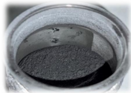
Рисунок 2.1 – Схема синтеза нанокompозита FeCo/C-N, фотография порошка
